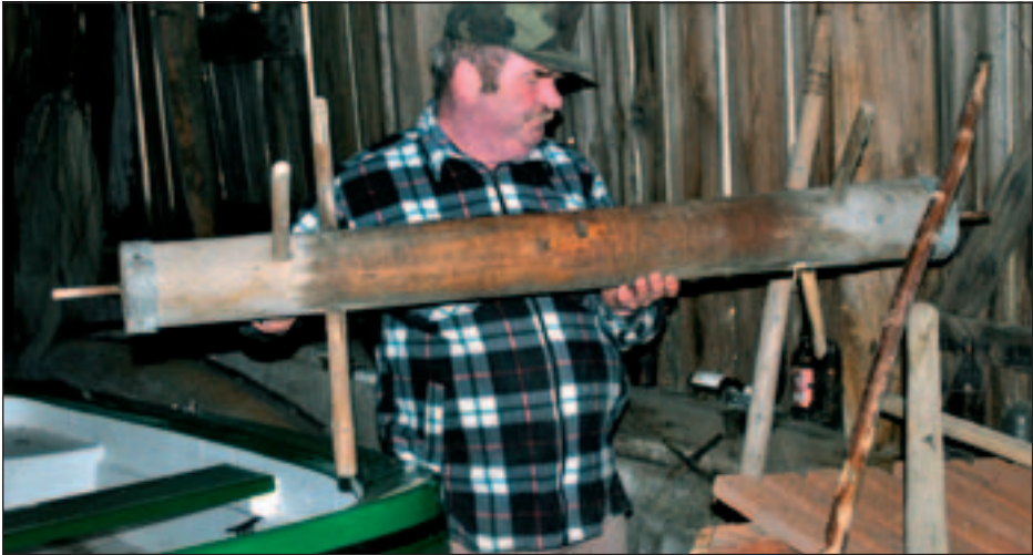
12. Kołowrót łodziowy bok do ciągnięcia sieci letnich, Łączyno-Hel, gmina Stężycza (fot. K. Zamościński)
