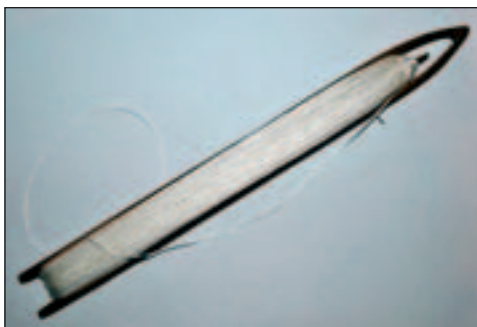
59. Drewniana igła ( kleszczka ) do szycia i naprawy sieci rybackich, Brodnica Dolna, gmina Kartuzy (fot. K. Zamościński)
